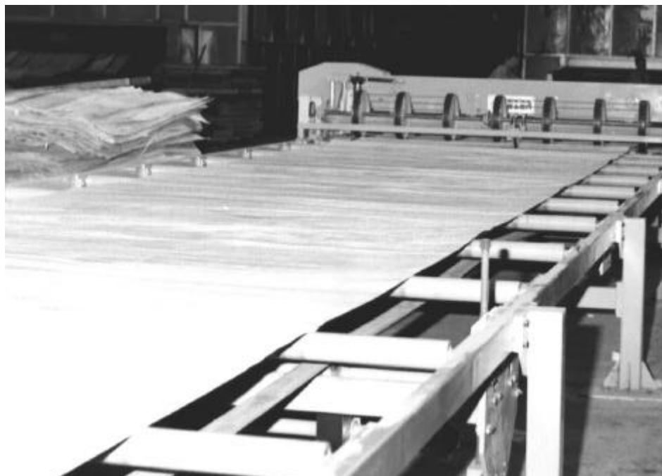
FIGURA 2 – Lâmina em produção por processo de desenrolamento.
